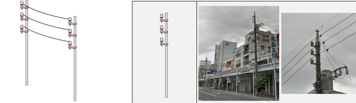
防護管を取付する高圧線の両側の電柱の装柱が異なる場合
